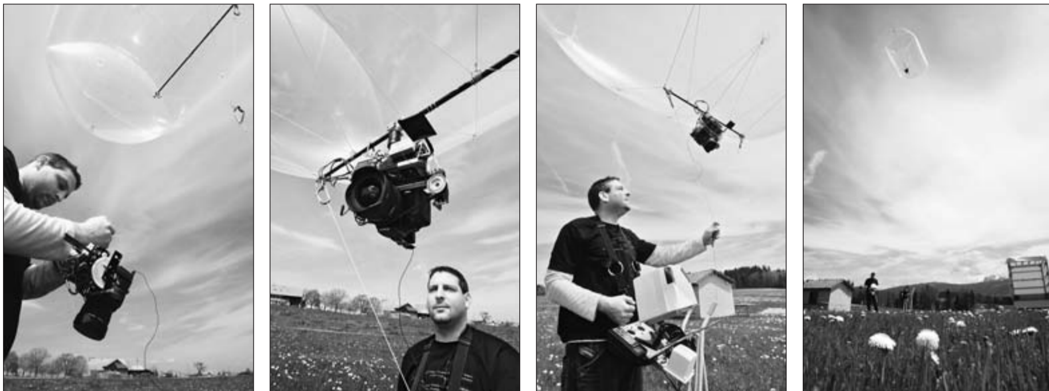
L'appareil de photo numérique est suspendu sous un gros ballon gonflé à l'hélium. Le tout est relié à la terre ferme grâce à un câble qui s'enroule et se déroule à volonté. Au sol, un écran permet à Gaël Handschin de visionner les images
